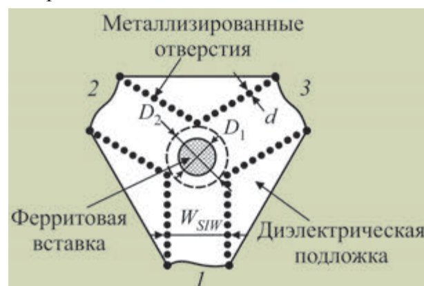
Рис. 1. Общий вид Y -циркулятора на основе ИПВ
