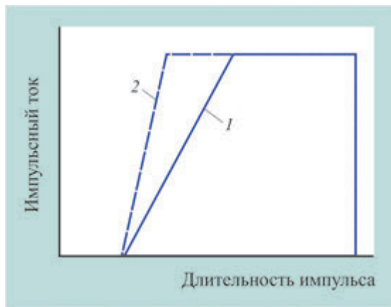
Рис. 11. Форма импульса тока в магнетроне: 1 – МПК; 2 – МОК
