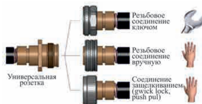
Рис. 3. Соединители 4.3–10 с разными механизмами сочленения вилки и розетки
