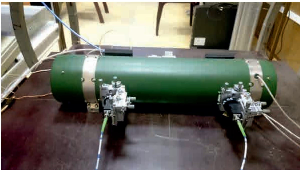
Рис. 10. Подключенная АЛТ-ЛН «Угорь» внутри катушек Гельмгольца
