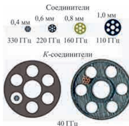
Рис. 7. Опорные диэлектрические шайбы соединителей 2,92 мм, 1,0 мм и 0,8 мм
