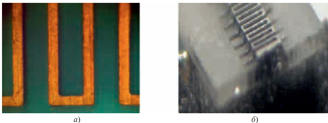
Рис. 18. Фотография части медного меандра (а) и изображение элемента заготовки ЗС после лазерной резки с оптического микроскопа (б)
