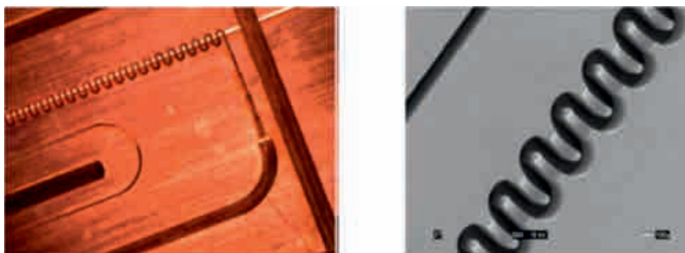
Рис. 15. Фотографии части ЗС, изготовленной с помощью нано-ЧПУ [59]
