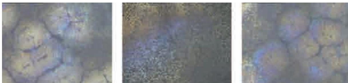
Рис. 6. Цвета побежалости на поверхности образцов CVD-алмаза после высоковольтных пробоев
