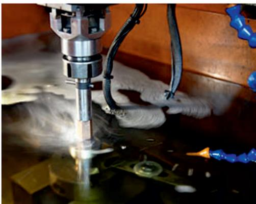
Рис. 1. Демонстрация процесса эрозионной прошивки отверстия профильным электродом
