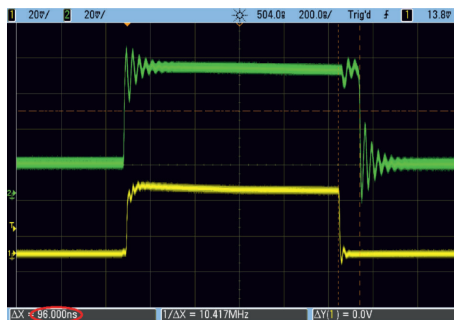
Рис. 2. Результаты измерений времени восстановления коэффициента передачи приемного канала после воздействия на вход импульса мощностью 8 Вт с одним генератором сигналов
