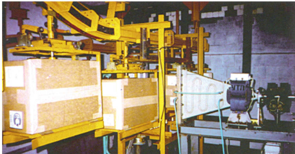
Рис. 2. Облучаемые изделия на конвейере в стерилизационном ускорительном центре АО «МРТИ РАН»
