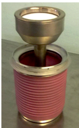
Рис. 4. Катодная ножка сверхмощного клистрона КИУ-257
