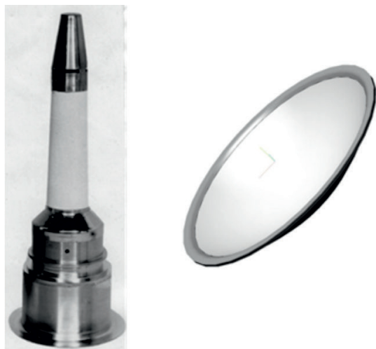
Рис. 9. Катоды магнетронной пушки и классического клистрона
