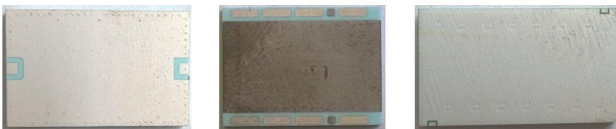
Рис. 7. Полосно-пропускающие фильтры с центральными частотами в диапазоне 2,1...3,6 ГГц
