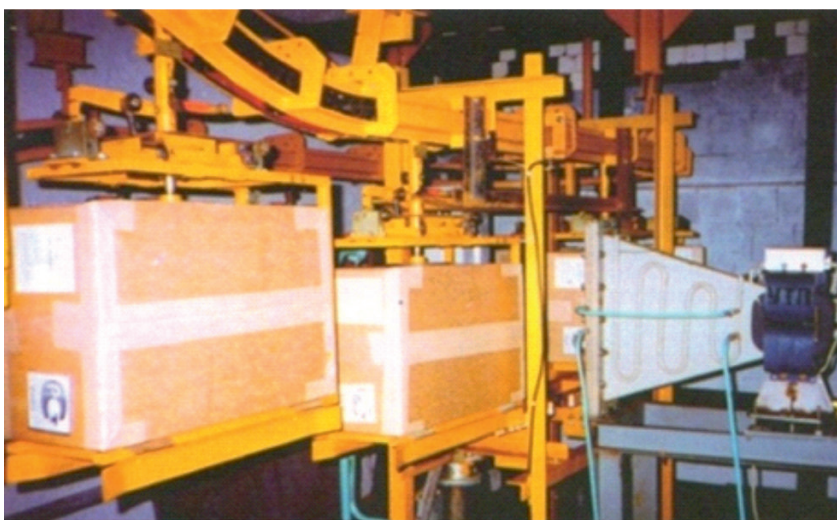
Рис. 3. Облучаемые изделия на конвейере в ускорительном комплексе АО «МРТИ РАН»
