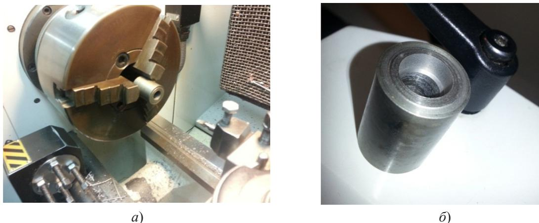
Рис. 6. Операция растачивание (а) и вид обработанной поверхности (б)
