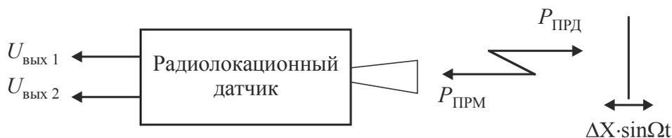
Рис. 3. Определение вибросмещений по фазе отраженного сигнала
