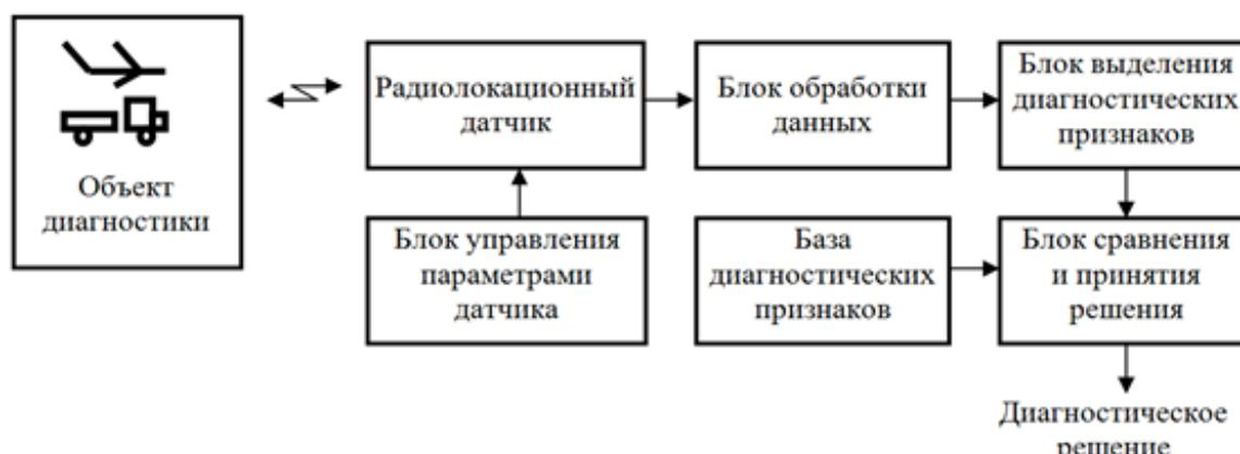
Рис. 2. Система радиолокационной диагностики
