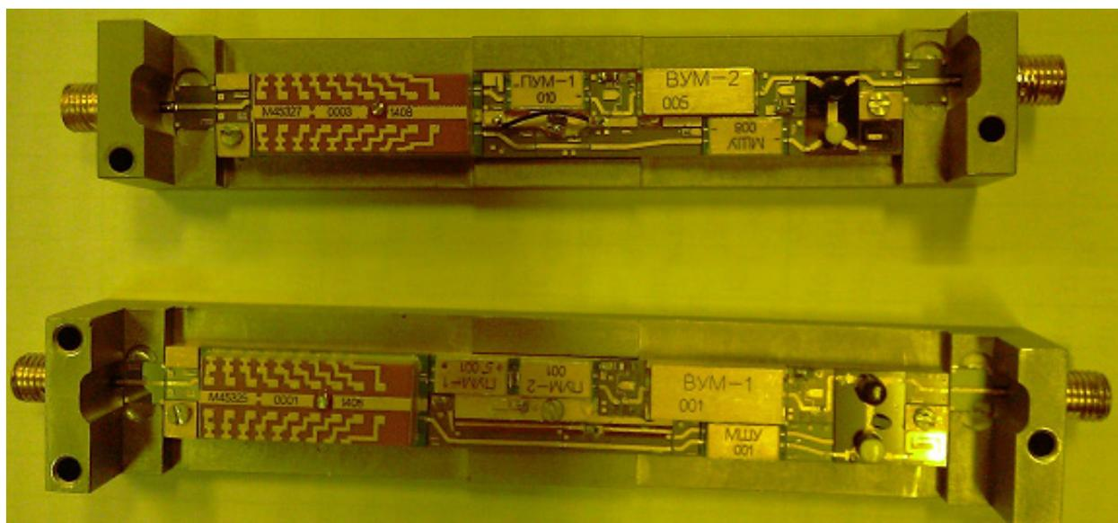
Рис. 2. Приемопередающий модуль АФАР 2-см диапазона
