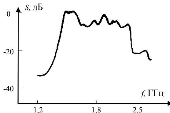
Рис. 7. Спектр сигнала генератора с согласующими цепями (табл. 3, номер 2)
